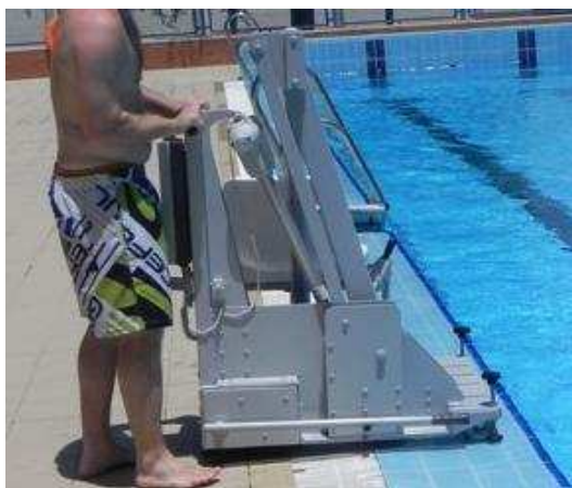
1. Przybliż podnośnik do krawędzi basenu (ok. 5-10 cm)
