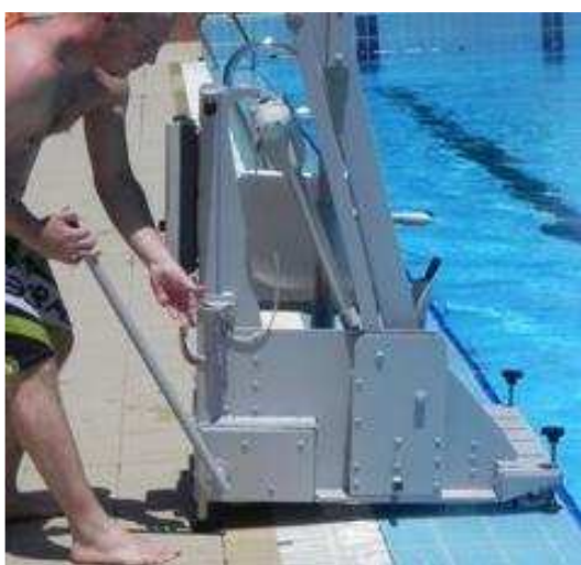
3. Obróć część zabezpieczającą dźwignię
