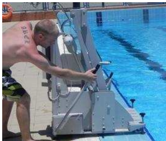
2. Aktywuj dźwignię bezpieczeństwa wspinającą tylnie koła
